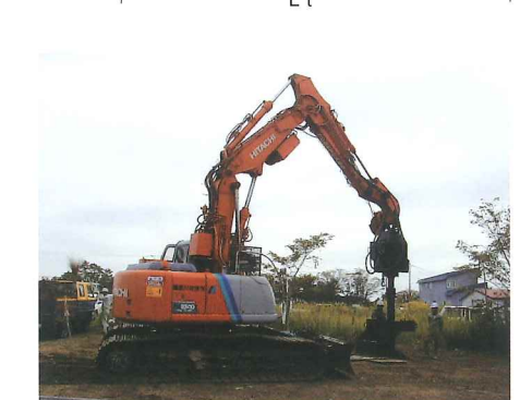
傾斜地などでの施工に適したリーダーレス施工機など、さまざまな条件に対応する施工機械を用意
